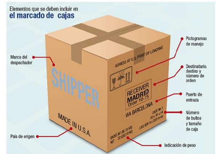
Figura 16 Etiquetas de Manipulación y Use Markings. Marcas y pictogramas en el comercio internacional. Revista de Logística.
