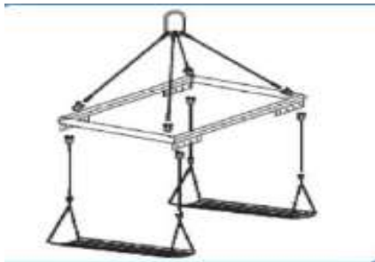
Figura 40. Mani Obra Levante de Camiones S.W.L. 20-30 ton Según Maquinaria utilizada en puertos fuente (Racine, 2014)
