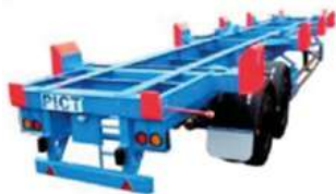
Figura 33. Bomb Carts según Maquinaria utilizada en puertos fuente (Racine, 2014)
