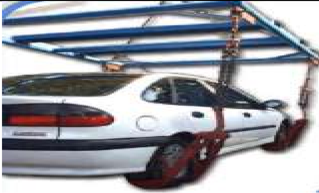
Figura 42. Maniobra para levante de automóviles con mordazas ajustables, Según Maquinaria utilizada en puertos fuente (Racine, 2014)
