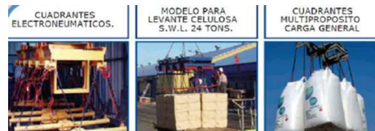
Figura 38. Equipos neumáticos para cargas generales según Maquinaria utilizada en puertos fuente (Racine, 2014)
